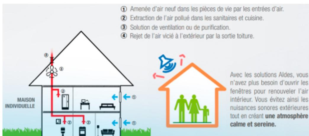
*Principe de la ventilation VMC si simple flux*
