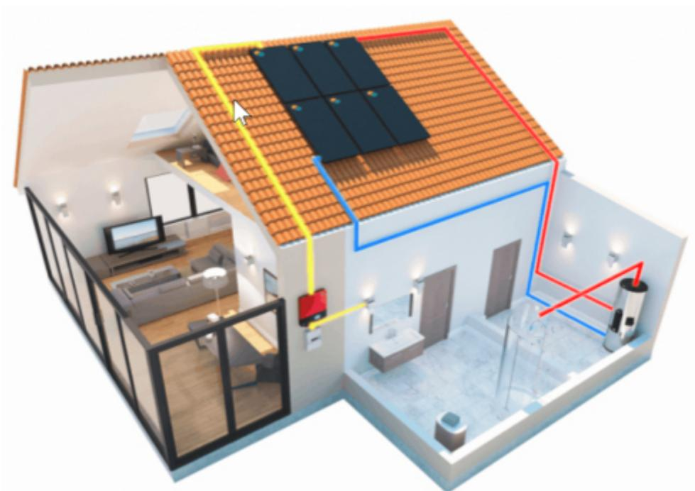
*Principe de fonctionnement de panneaux solaires hybrides – Source Dualsun*
