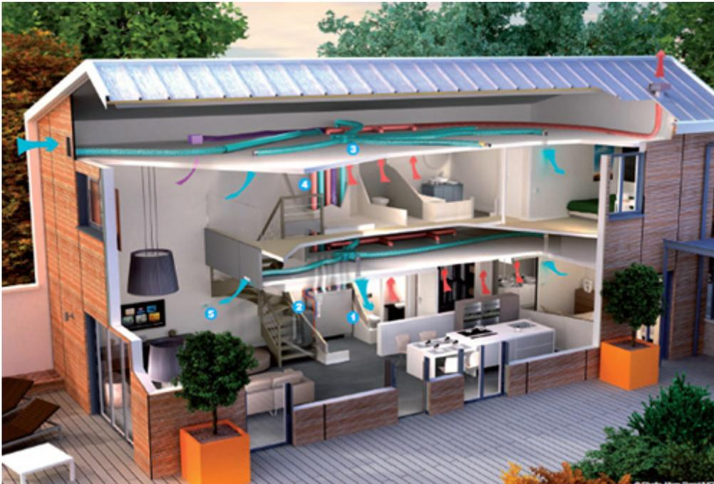
*Exemple de logement équipé d'un système avec un chauffe-eau thermodynamique + VMC double flux, assurant la ventilation, le chauffage et le rafraîchissement de la maison*
