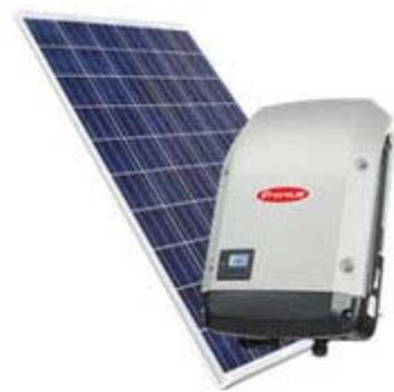
L'électricité solaire, produite et transformée par l'onduleur, sera utilisée pour les besoins d'électricité du bâtiment. A partir d'un certain seuil de puissance PV réglable, le gestionnaire d'énergie couplé à l'onduleur active la mise en marche de la PAC afin de stocker le surplus d'électricité sous forme de chaleur dans un ballon tampon pour couvrir les besoins ultérieurs de chauffage et d'eau chaude sanitaire.
