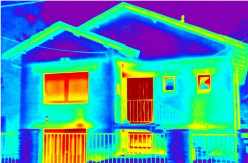
*Thermographie faite avec une caméra infra-rouge permettant de détecter les déperditions*
