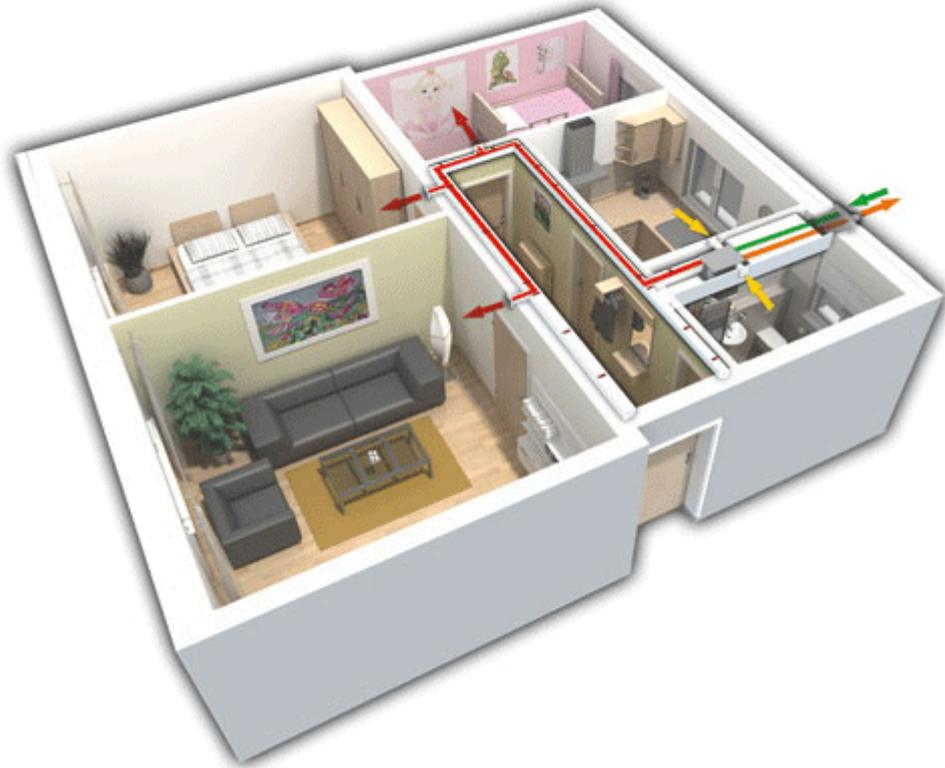
Schéma de gaines VMC intégrées dans corniche en rénovation
