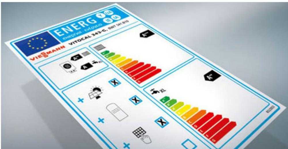
*Etiquette énergétique d'un système de chauffage combiné avec en base une pompe à chaleur*
