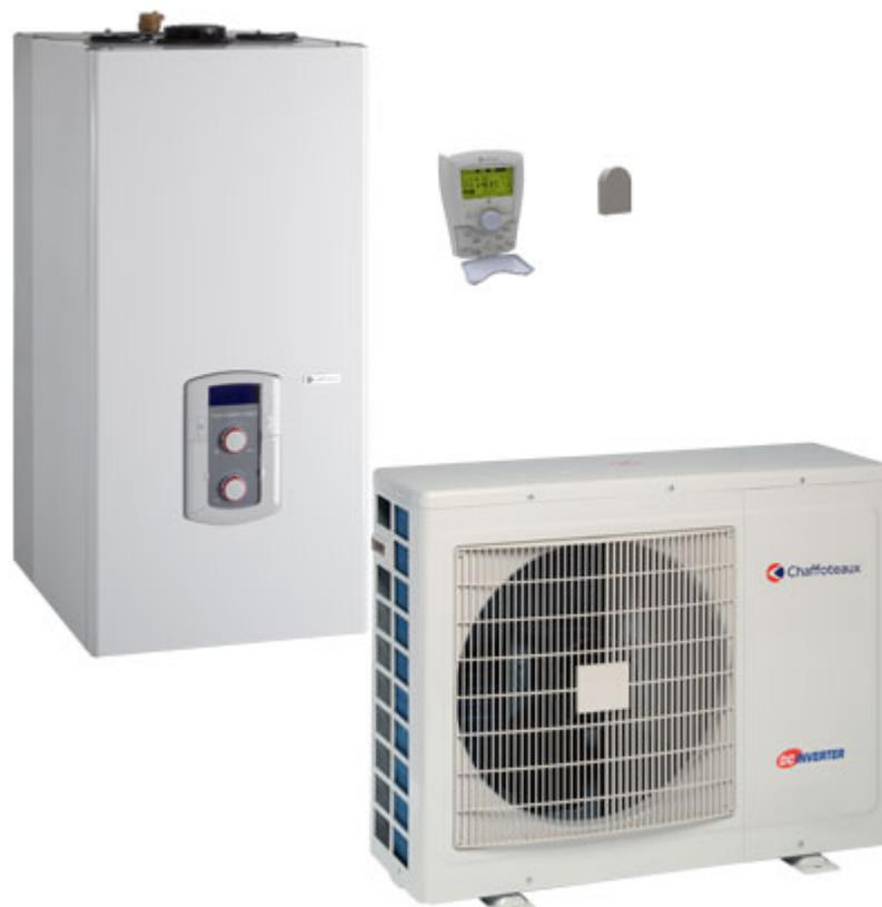
La pompe à chaleur hybride est un générateur mixte composé d'une pompe à chaleur air/eau de petite puissance généralement inférieure à 5 kW, et d'une chaudière à condensation. La chaudière fournissant 100 % des besoins d'eau chaude sanitaire et une partie des besoins de chauffage.
