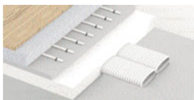
Conduit plat en chape de ravaillage
