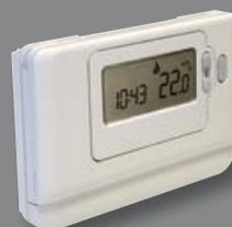
Un thermostat d'ambiance sans fil, dont le récepteur possède une portée de 30 m, est disponible en option. Il peut se fixer au mur de la pièce, et permet de piloter une PAC Estia, en fonction de la consigne de température ambiante. Ce thermostat est équipé d'une programmation horaire avancée et du mode « vacances ». Il doit être installé avec la carte TCB-PCM03E.
